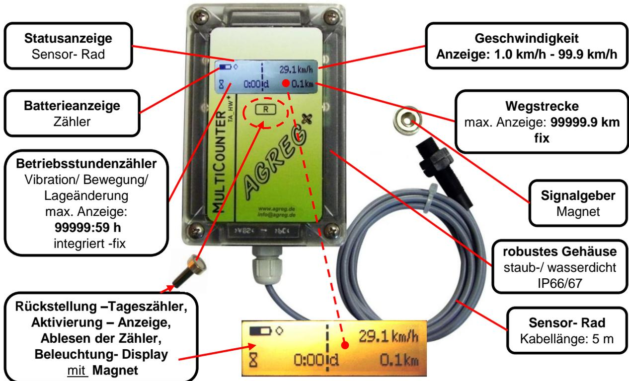
**Tachometer mit Betriebsstundenzähler:** Anbau an Traktoren, Fahrzeugen
