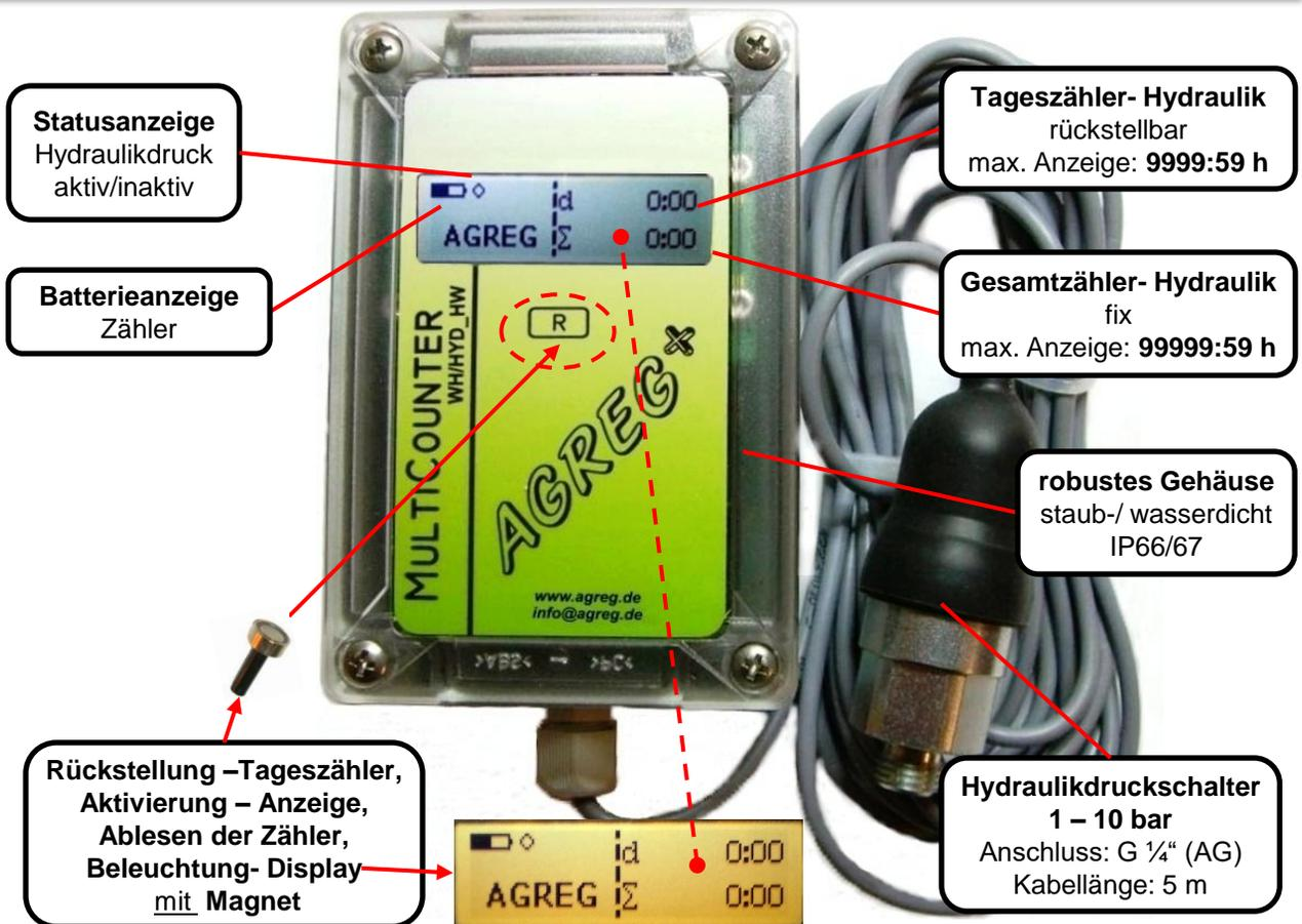
**Betriebsstundenzähler** für Maschinen, Fahrzeuge, Geräte mit **Hydraulik**
