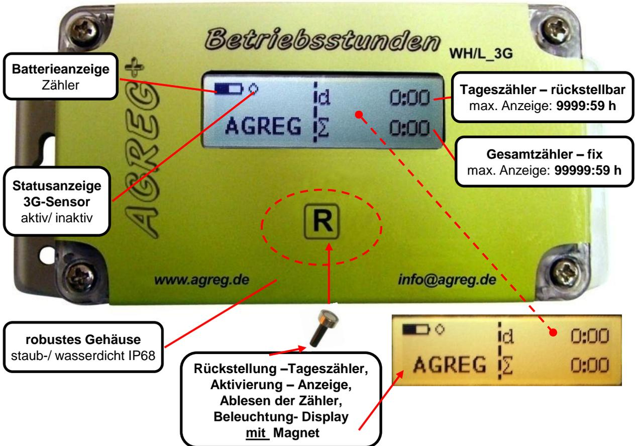
**Betriebsstundenzähler** für (fast) alle Fahrzeuge, Geräte und Maschinen
